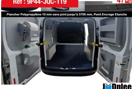
**EXPERT LONG-Kit + Portes Ar Hautes Plancher Antidérapant Polypropylène Light 1 Plc (Porte Latérale Electrique)**
