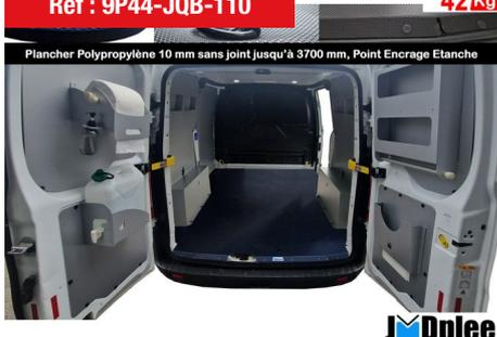
**EXPERT STANDARD-Kit + Portes Ar Hautes Plancher Antidérapant Polypropylène Light 1 Plc**
